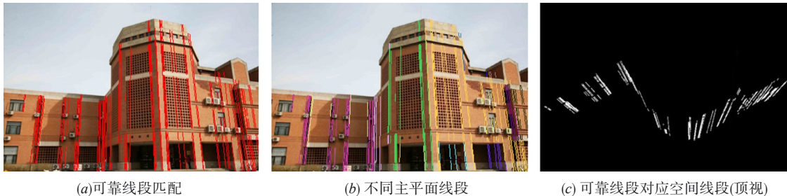
图4 建筑主平面抽取(不同主平面上的线段由不同颜色表示)
